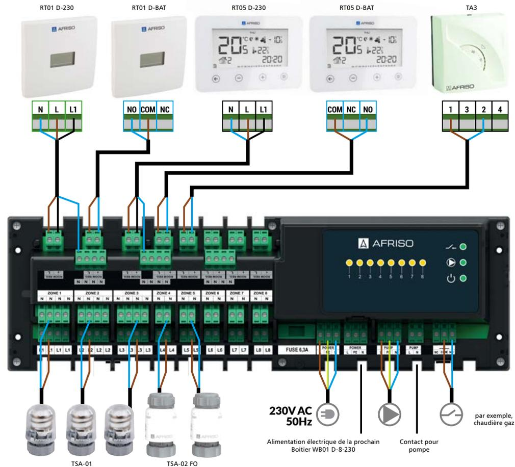
Fig. 4 Connexions électriques
